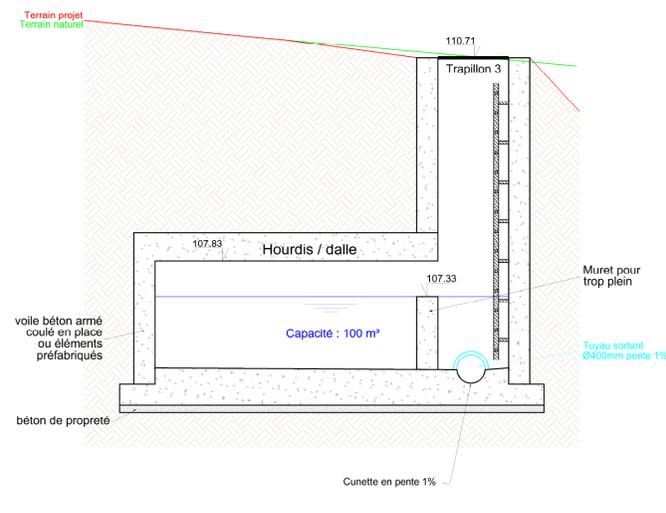
L'épaisseur des voiles, poutres et dalles peut varier selon la technique utilisée pour leur réalisation. Cette épaisseur sera définie et garantie par une étude de stabilité + plans de détails fournis par l'Entrepreneur.
